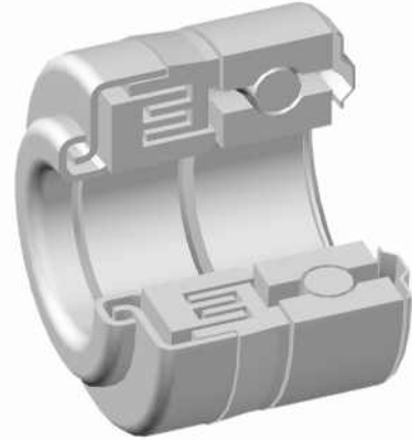
Uszczelnienie labiryntowe (z odrzutnikiem)- Typ N The labyrinth seal (with thrower) - Type N Лабиринтное уплотнение вместе с отражателем - тип Н
